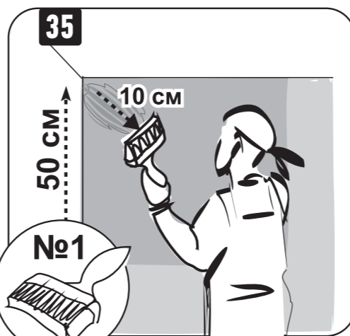
Возьмите КИСТЬ №1. Приставьте в верхний левый угол и, прижимая к стене, проведите мазок вниз и вправо длиной 10 см
