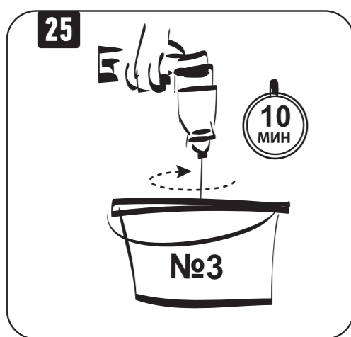
Перемешивайте содержимое ведра №3 дрелью с мешалкой не менее 10 мин.
