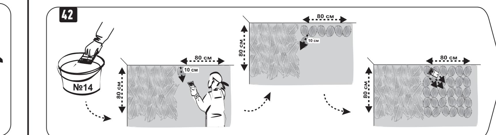
Обновите материал на кисти и, повторяя действия 32-41, нанесите еще один участок, а затем таким же способом всю поверхность.
